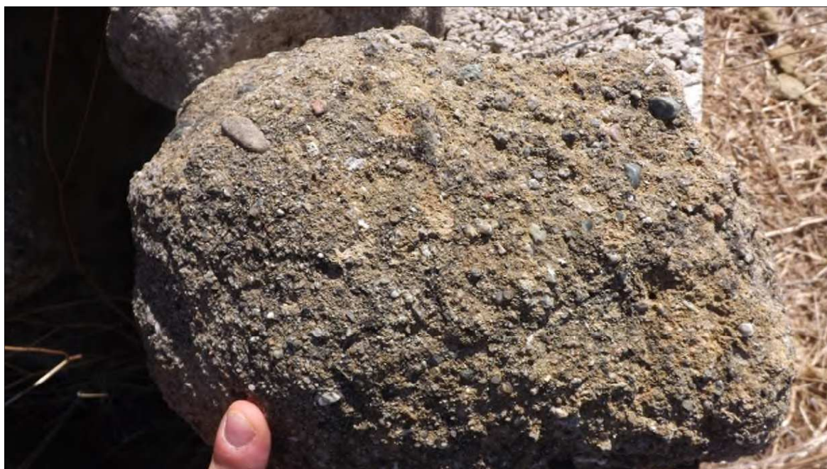
Figura 2.1.4 Affioramento della Successione vulcano – sedimentaria oligo-miocenica del Campidano – Sulcis, Formazione di Nurallao, Arenarie di Serra Longa. Campione a mano di microconglomerato che alla scala di affioramento presenta stratificazione incrociata o parallela.
