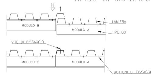
n.b. PREVEDERE ASSEMBLAGGIO A TERRA PRIMA DEL POSIZIONAMENTO I MODULI SONO UGUALI DA A/L AD A\*/L\*, COME DA 1/4
