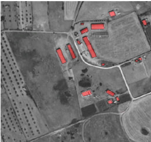
Fig. 9 – Digitalizzazione degli edifici da ortofoto 1:10.000
